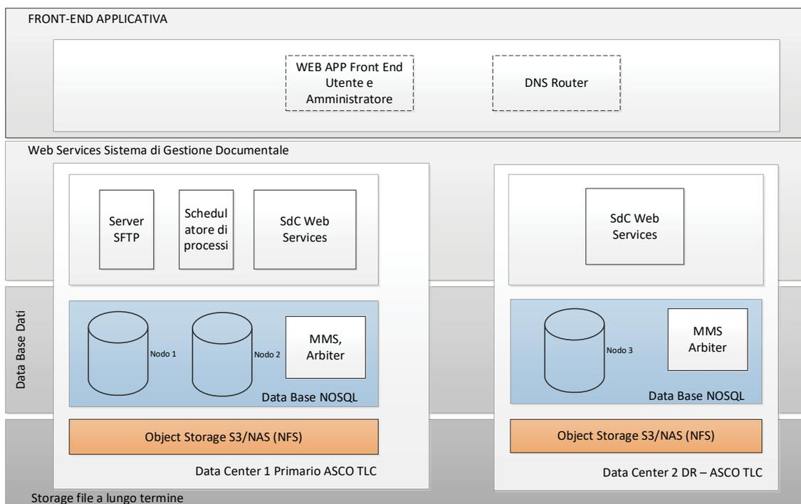
**Figura 13 Componenti logiche del Sistema di Conservazione Strongdox**
